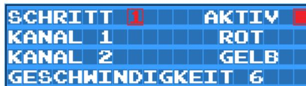
• Mit der "auf" bzw. "ab" Taste des Steuerkreuzes können Sie den einzustellenden Lauflichtschritt auswählen. Links im Display wird angezeigt ob der ausgewählte Lauflichtschritt aktiviert (ausgefülltes Quadrat) oder deaktiviert (leeres Quadrat) ist bzw. mit der "mitte" Taste des Steuerkreuzes können Sie den Zustand ändern. Das Lauflicht durchläuft immer die Schritte beginnend von 1-50 und startet dann wieder von 1-50 usw.. Ist ein Lauflichtschritt deaktiviert so wird dieser übersprungen.
