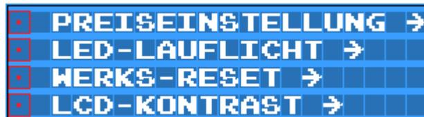
• Um eine dieser Funktionen auszuwählen, bewegen Sie den Cursor an die entsprechende Stelle und betätigen Sie die "rechts" Taste des Steuerkreuzes. Die "Preiseinstellung" ist die Grundfunktion welche nach dem Einschalten des Preisschildes immer aktiv ist.
