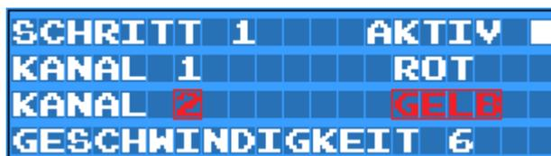
• Bewegen Sie den Cursor mit der "links" Taste des Steuerkreuzes auf "GESCHWINDIGKEIT" um mit der "auf" bzw. "ab" Taste des Steuerkreuzes die Ablaufgeschwindigkeit des gewählten Lauflichtschrittes einzustellen:
